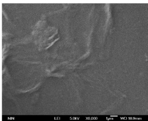
图 3 石墨烯修饰电极的电镜扫描图
