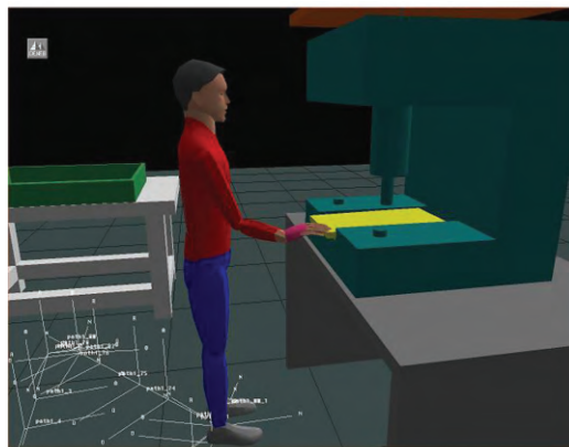
图2 将零件放到模座前,推入模座中定位
