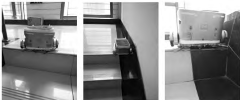
图 20 清洁机器人探空次数与覆盖率实验
